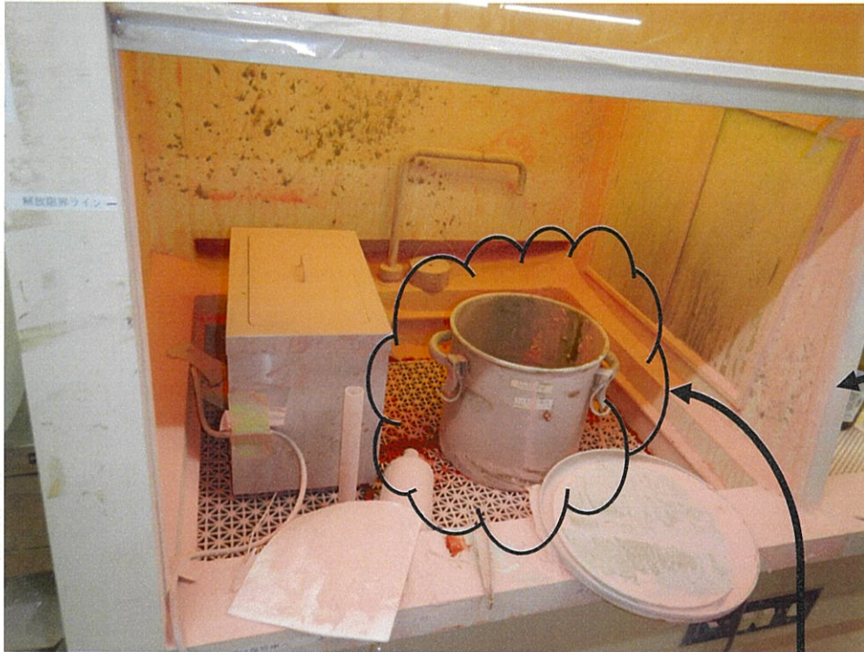
◎フード内写真（発火場所）
